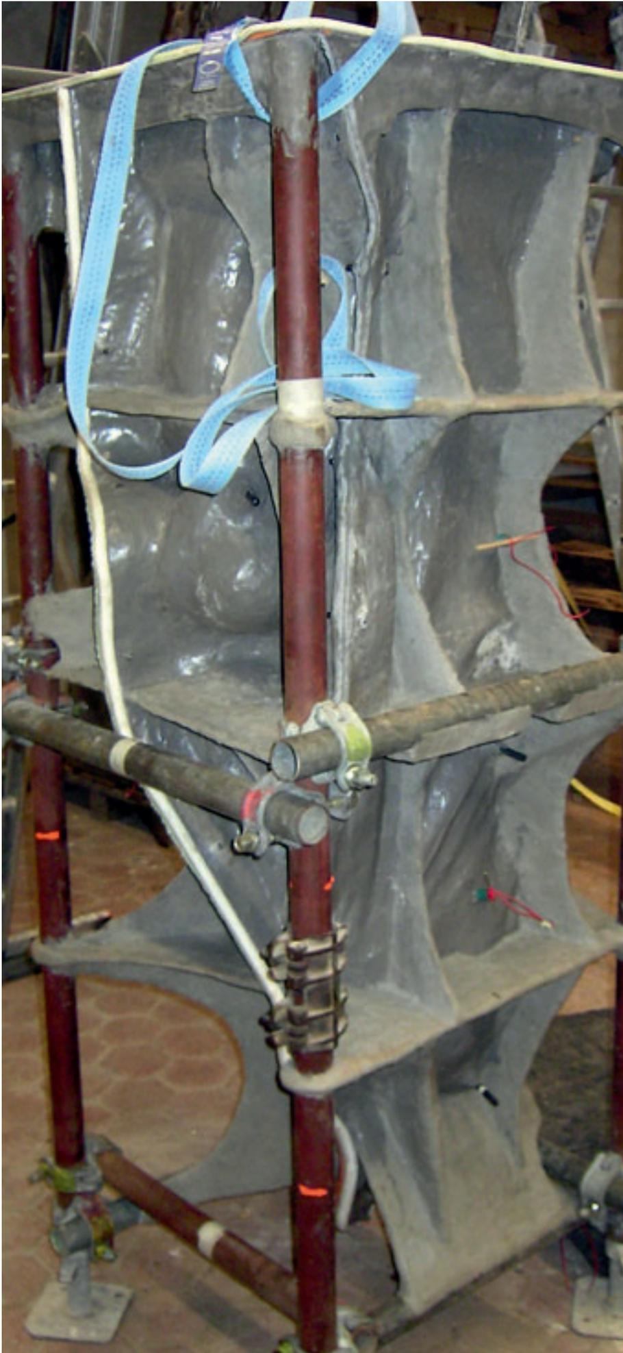
22 Form fertig zum Reproduktionsguss
