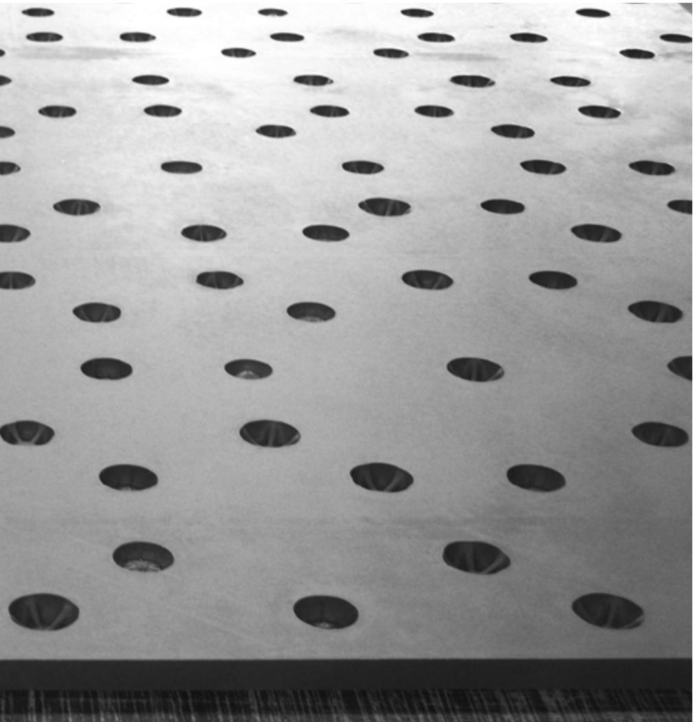
**RECKLI Strukturmatrizen bestehen aus gummiähnlichen Polyurethan-Elastomeren, durch deren hohe Flexibilität und Elastizität ein beschädigungsfreies Entschalen der Betonsichtflächen und eine millimetergenaue und scharfkantige Wiedergabe des Texturprofils erreicht werden kann. RECKLI Matrizen können sowohl in der Elementvorfertigung als auch im Ortbeton eingesetzt werden.**
