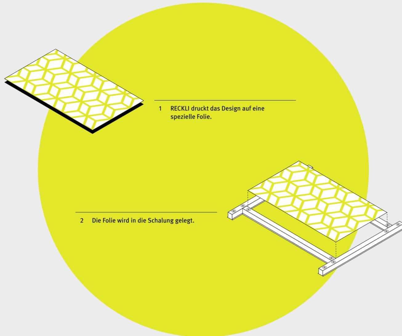
1 RECKLI druckt das Design auf eine spezielle Folie.
