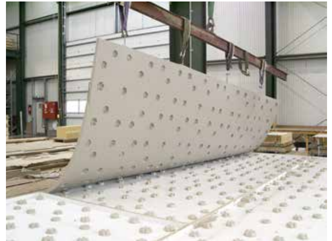
ABDRÜCKE DER PET-FLASCHEN WURDEN IM VORGEgebenEN STREUMUSTER AUF DEM POSITIV PLATZIERT. ANSCHLIESSEND WURDE DIE MATRIZE GEFERTIGT. IMPRINTS OF A PET BOTTLE HAVE BEEN PLACED IN A PREDETERMINED SCATTER PATTERN ON THE POSITIVE MODEL. AFTERWARDS THE FORMLINER WAS CASTED.
