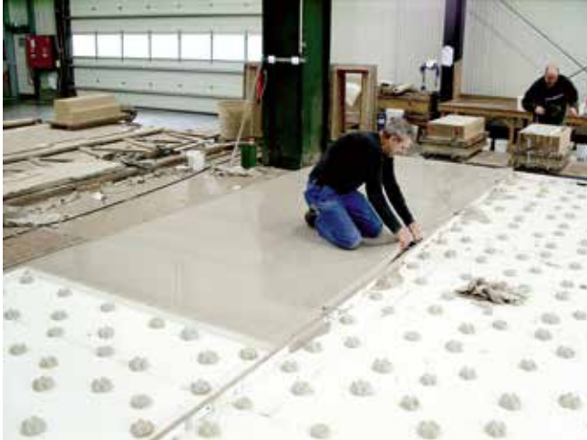
ABDRÜCKE DER PET-FLASCHEN WURDEN IM VORGEgebenEN STREUMUSTER AUF DEM POSITIV PLATZIERT. ANSCHLIESSEND WURDE DIE MATRIZE GEFERTIGT. IMPRINTS OF A PET BOTTLE HAVE BEEN PLACED IN A PREDETERMINED SCATTER PATTERN ON THE POSITIVE MODEL. AFTERWARDS THE FORMLINER WAS CASTED.
