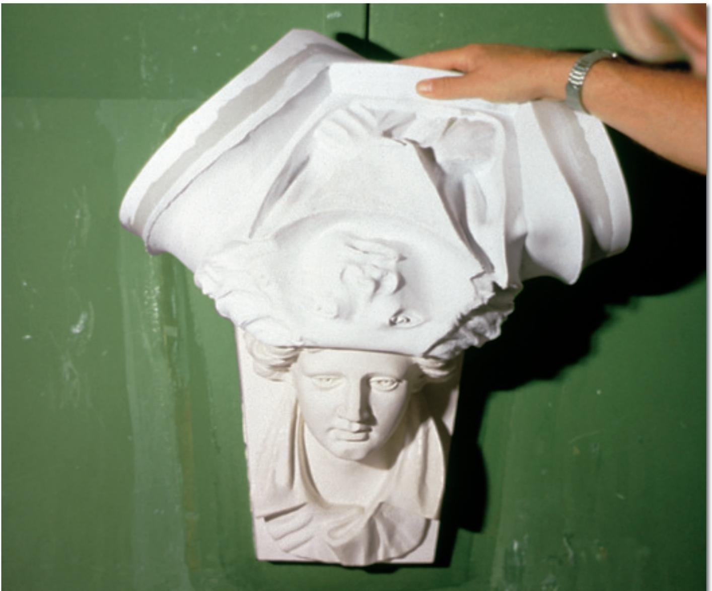
Entschalung einer einteiligen Massivform aus SI-Elastomer
