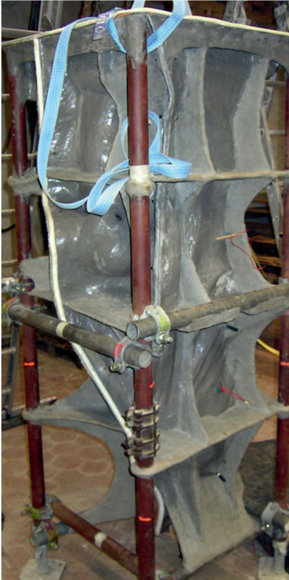
22 | Form fertig zum Reproduktionsguss
