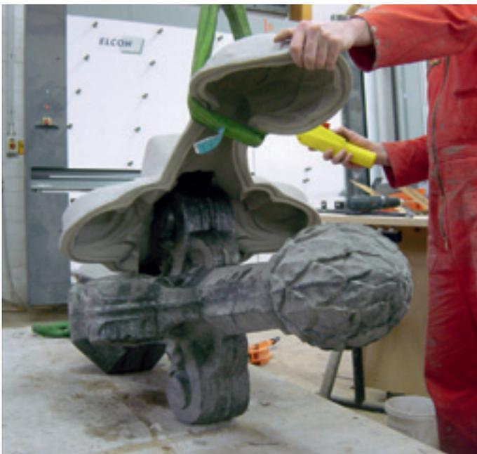
Entschalung einer 2-teiligen Mantelform aus PUR-Elastomer
