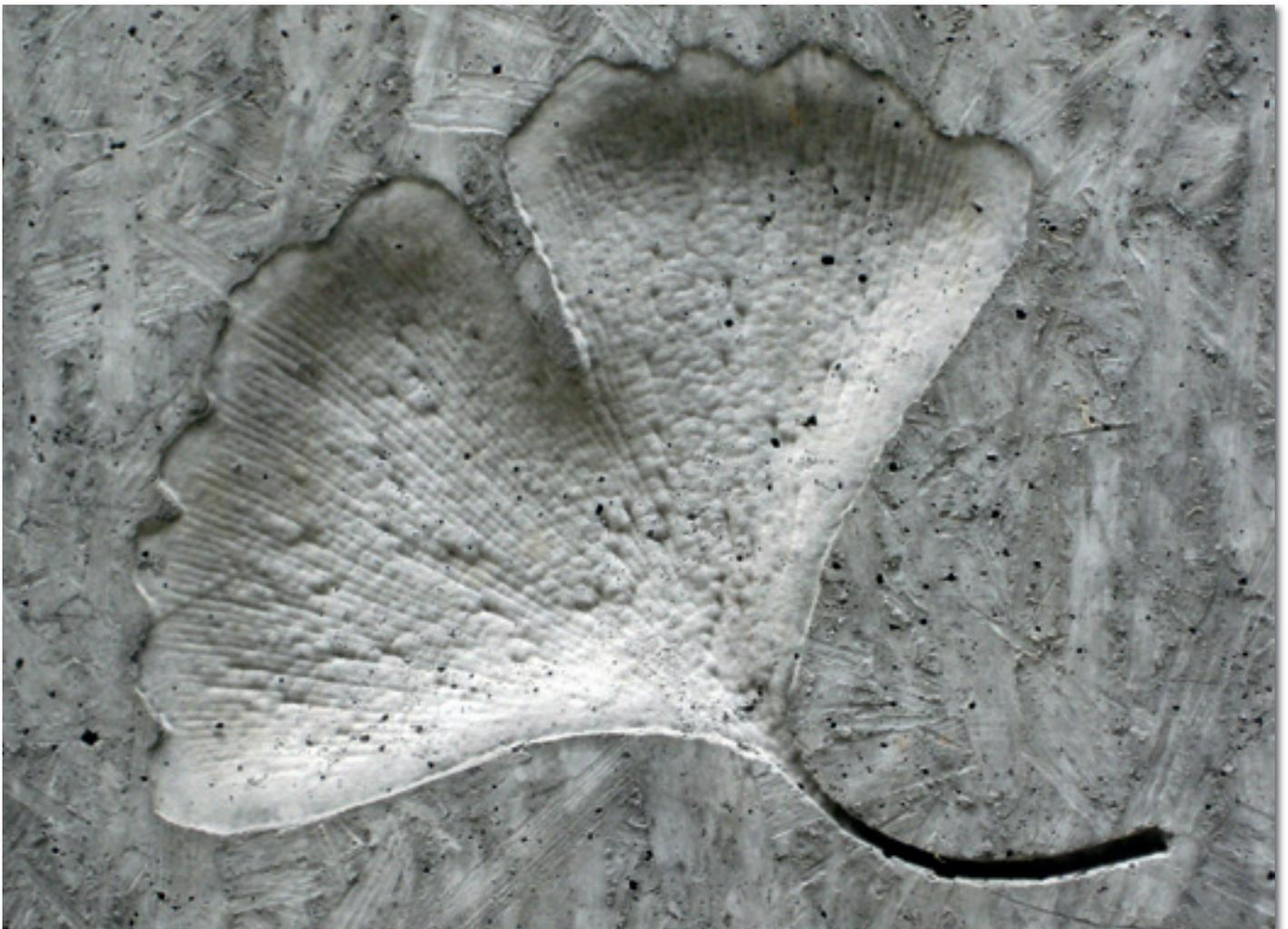
*Mit PUR-Elastomer abgeformtes Ginko-Blatt - Betonrelief*
