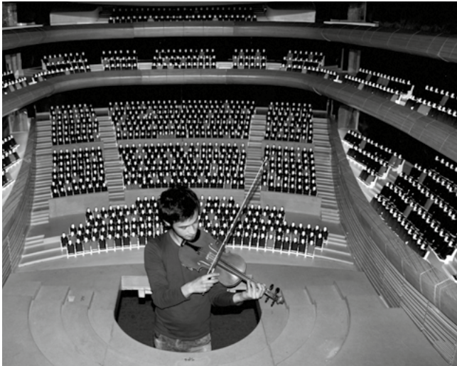
FÜR DIE AKUSTIK-TESTS BAUTE NAGATA ACOUSTICS EIN MODELL IM MASSSTAB 1:10.
