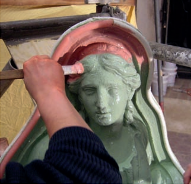
17 Aufstreichen der dritten Silikonschicht auf die zweite Formenhälfte
