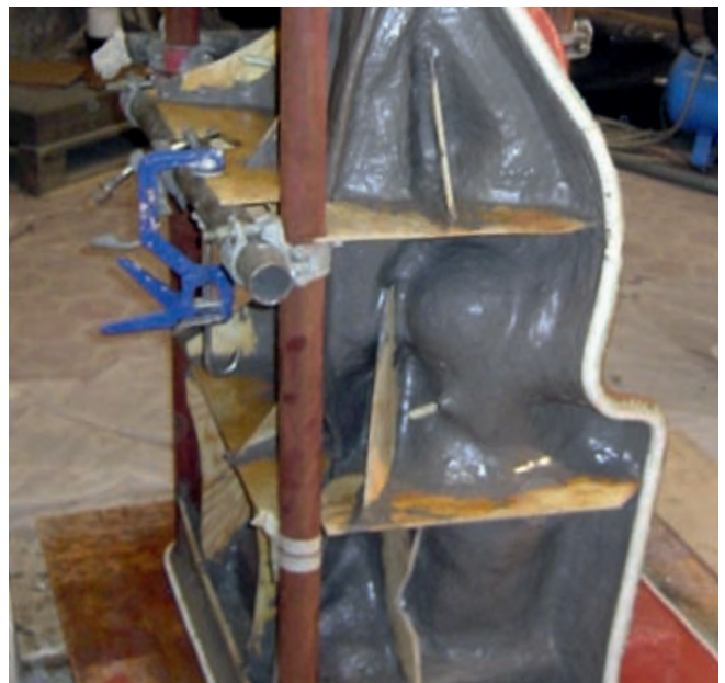
16 Abstützung und Verspannung der ersten Formenhälfte
