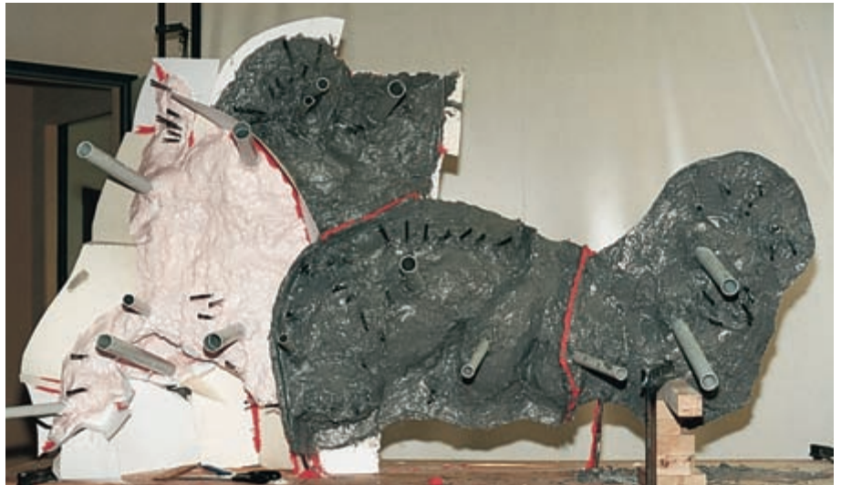
Triton aus dem Schloss Branitz Äußerst aufwendige Abformungsarbeit MODELL: Bronze FORM: RECKLI Si-Gießmasse 20 mit RECKLI Si-Verdicker flüssig K STÜTZFORM: RECKLI Epoxi-GF Spachtel REPLIKAT: RECKLI PUR-Gießmasse A75, nachkoloriert
