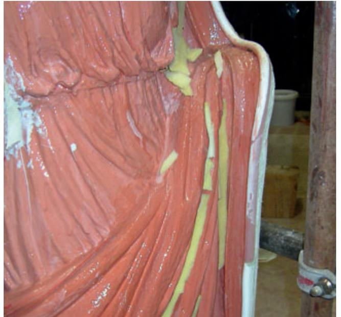
18 Remplissages de mousse pour le drap en contre-dépouille
