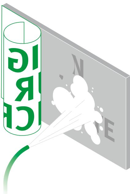
DIE FOLIE WIRD ENTFERNT UND DER BETON MIT EINEM HOCHDRUCKREINIGER AUSGEWASCHEN.
